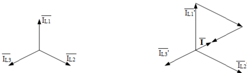
Slika 2.10. Vektorski prikaz promjene iznosa struja po fazama [6]
