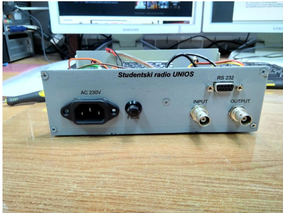
Slika 3.7. Prikaz stražnje strane RDS koder
