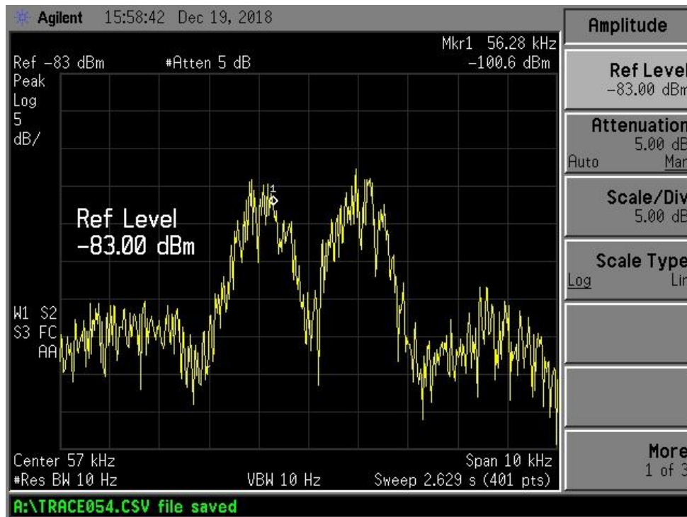
Slika 4.8. Prikaz spektra signala kada nema signala generatora (pilot signala)
