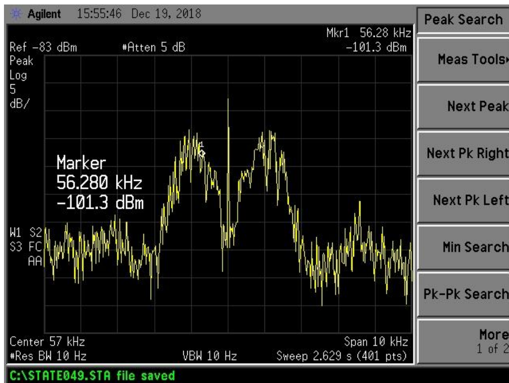
Slika 4.7. Prikaz spektra signala uz signal generatora (pilot signalfrekvencije 57 kHz i amplitude 6,9 V)
