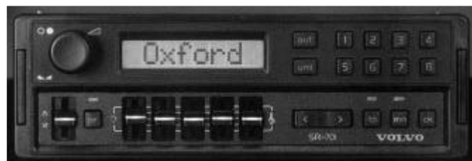
Slika 2.2. Volvo 701, prvi komercijalni RDS auto prijemnik, 1987 godina.[7]
