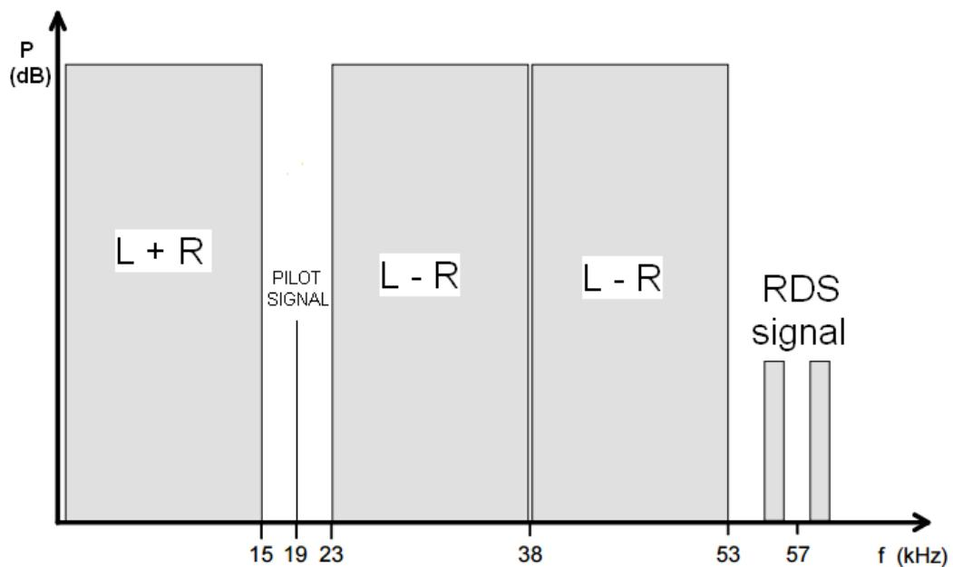
Slika 3.1. Spektar signala stereo muntilpleksnog signala sa spektrom RDS –a.
