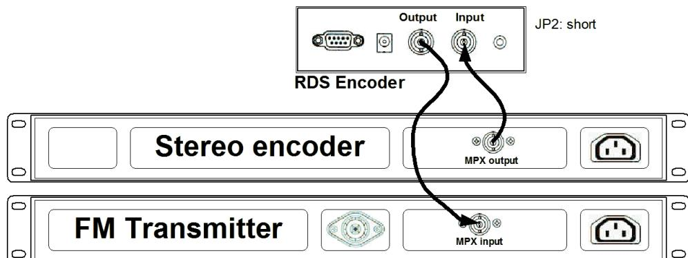
Slika 4.1. Stereo koder i FM odašiljač sa samo jednim MPX konektorom[8]
