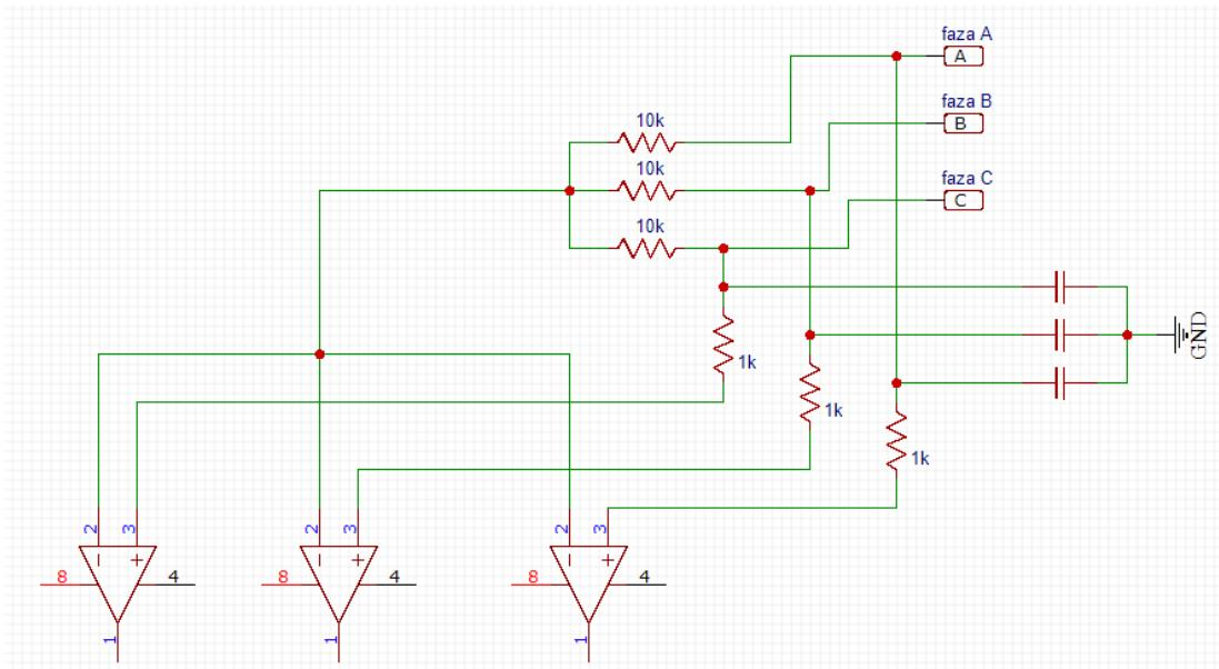
Slika 3.15: shema sklopa za detekciju prijelaska BEMF-a faza
