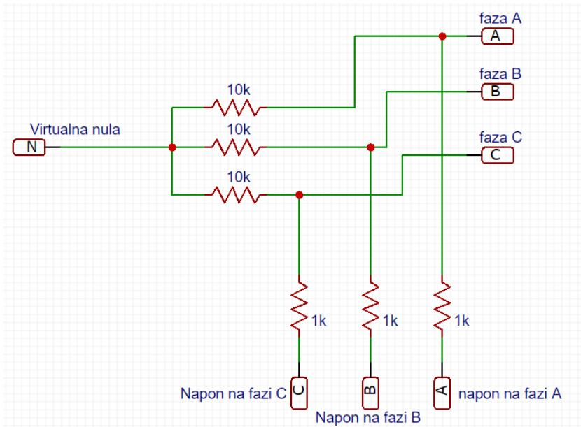
Slika 3.14: Shema za mjerjenje napona na fazama
