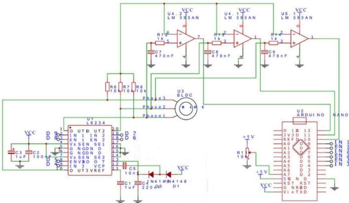
Slika 4.4: shema drugog sklopa za upravljanje BLDC motorom
