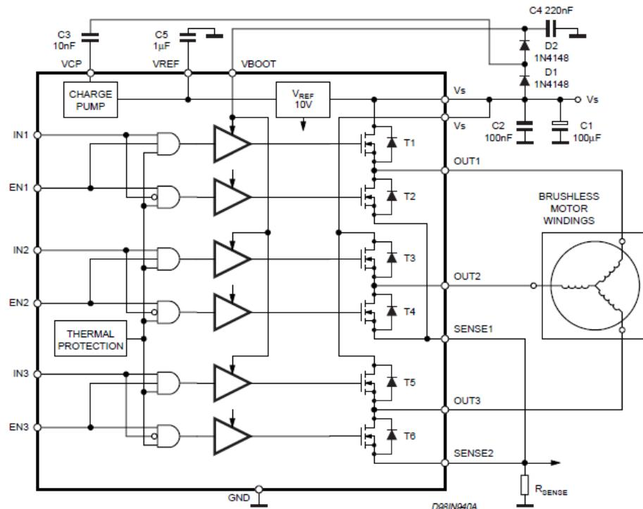
Slika 4.2: Topologija i primjer spajanja integriranog strujnog kruga LM6234
