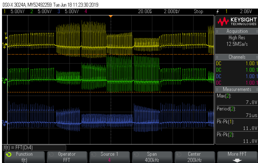
Slika 5.3: Napon na fazama motora u manjem vremenskom intervalu
