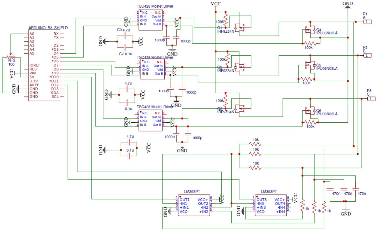
Slika 4.1: shema prvog sklopa za upravljanje BLDC motorom
