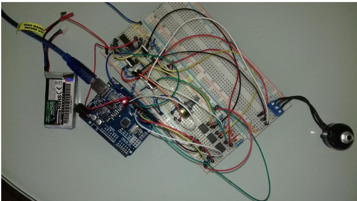
Slika 5.1: Izrađeni sklop za upravljanje BLDC motorom
