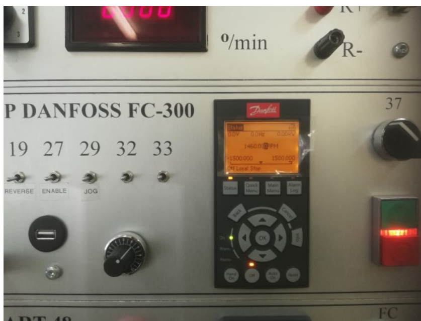
Slika 4.9: Upravljački panel frekvencijskog pretvarača
