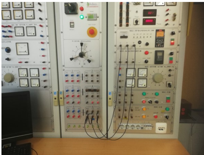
Slika 4.8: Spajanje asinkronog motora na frekventijski pretvarač
