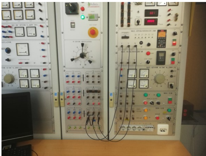
Slika 4.8: Spajanje asinkronog motora na frekvencijski pretvarač
