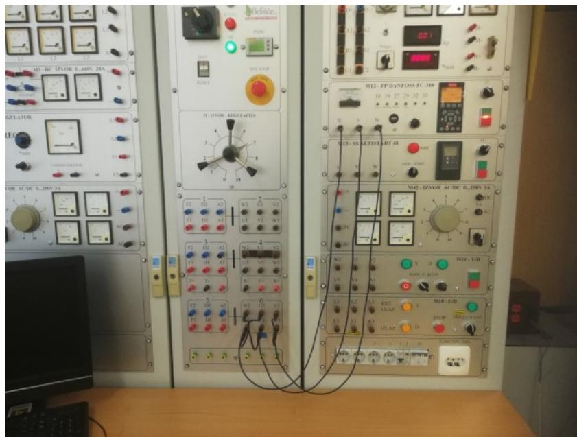
Slika 4.8: Spajanje asinkronog motora na frekvencijski pretvarač
