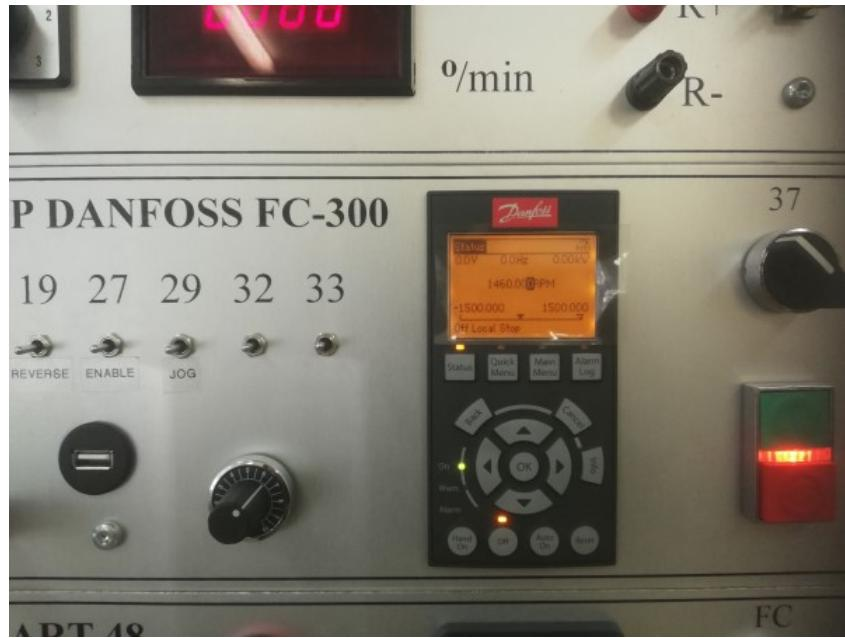
**Slika 4.9:** Upravljački panel frekvencijskog pretvarača
