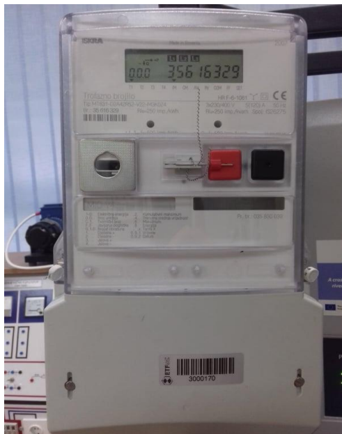
Slika 3.7. Prikaz naprednog trofaznog višefunkcijskog brojila Iskra MT831
