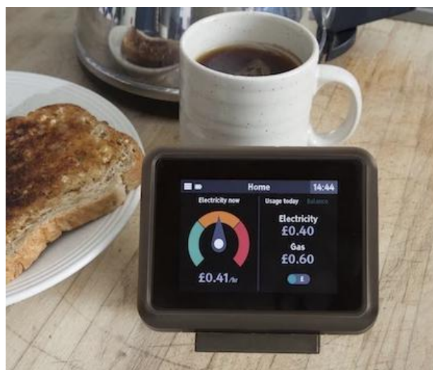
Slika 3.2. Jedinica za kućni prikaz [8]
