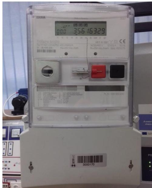
Slika 3.7. Prikaz naprednog trofaznog višefunkcijskog brojila Iskra MT831
