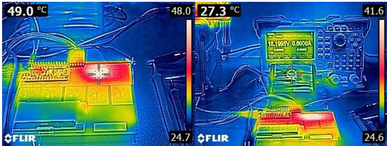
**Slika 4.4.** Raspodjela temperature sustava i baterije tijekom balansiranja
