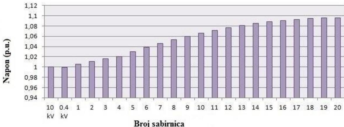
Sl.4.9. Naponski profil za scenarij s 7 kW fotonaponskih sustava proizvodnje i 1 kW potrošnje u kućanstvima, regulirano pomoći invertera fotonapona
