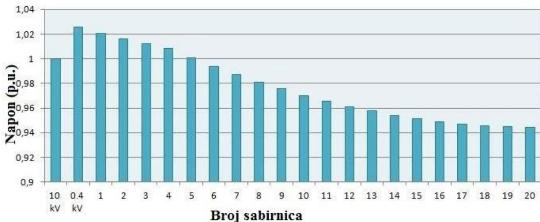
**Sl.4.9. Naponski profil za scenarij bez proizvodnje fotonaponskih sustava i 4,3 kW potrošnje u kućanstvu pomoći regulacijske preklopke transformatora**
