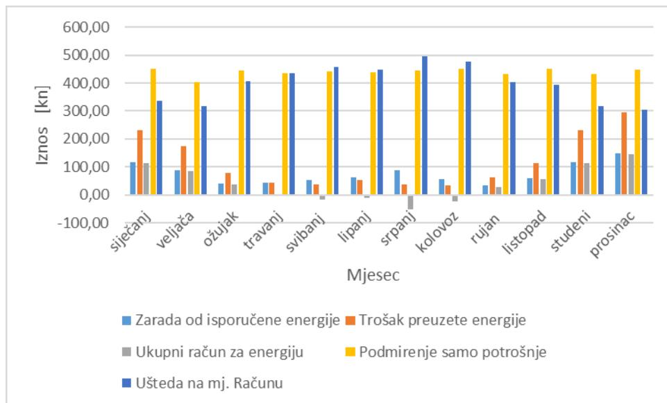
Slika 4.11. Mjesecni tok novca za sustav snage 4,5 kW plus 1 baterijski sustav pohrane
