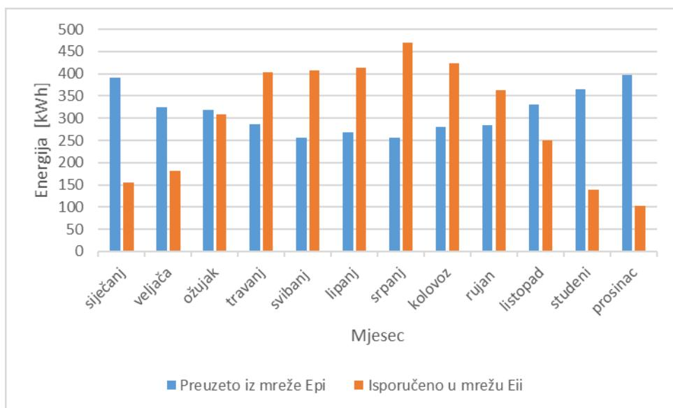
Slika 4.7. Mjesecni tok električne energije za sustav snage 4,5 kW
