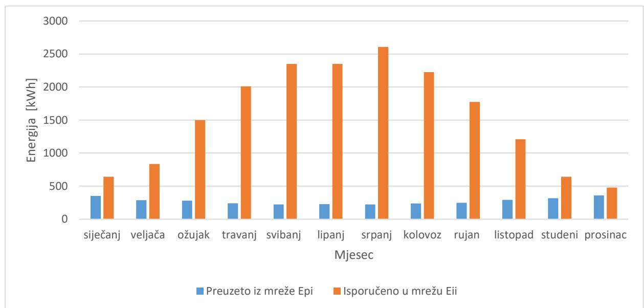
Slika 4.4. Mjesecni tok električne energije za sustav snage 18 kW
