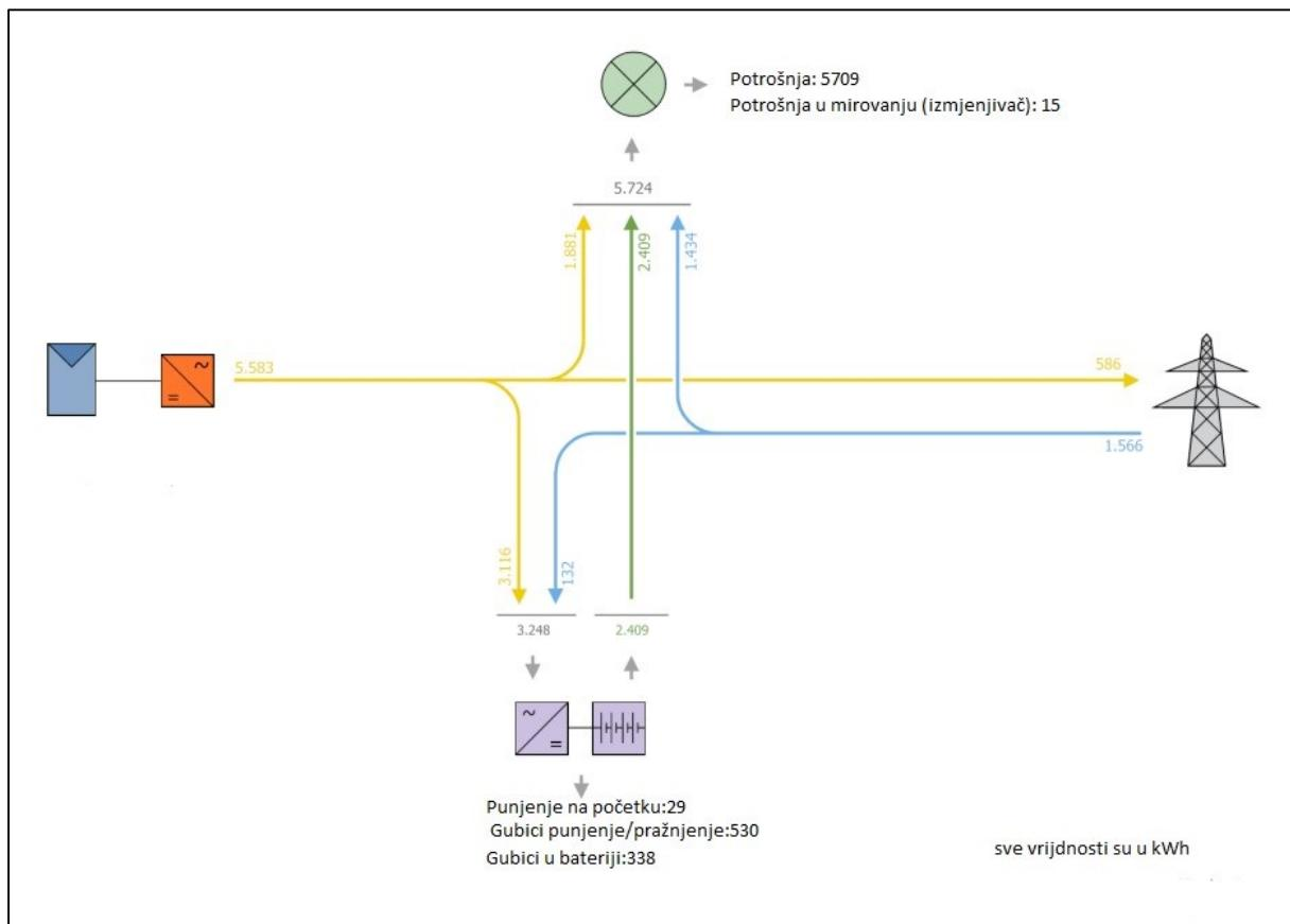
Slika 4.15. Tok energije 4,5 kW s pohranom 2 baterijski sustav
