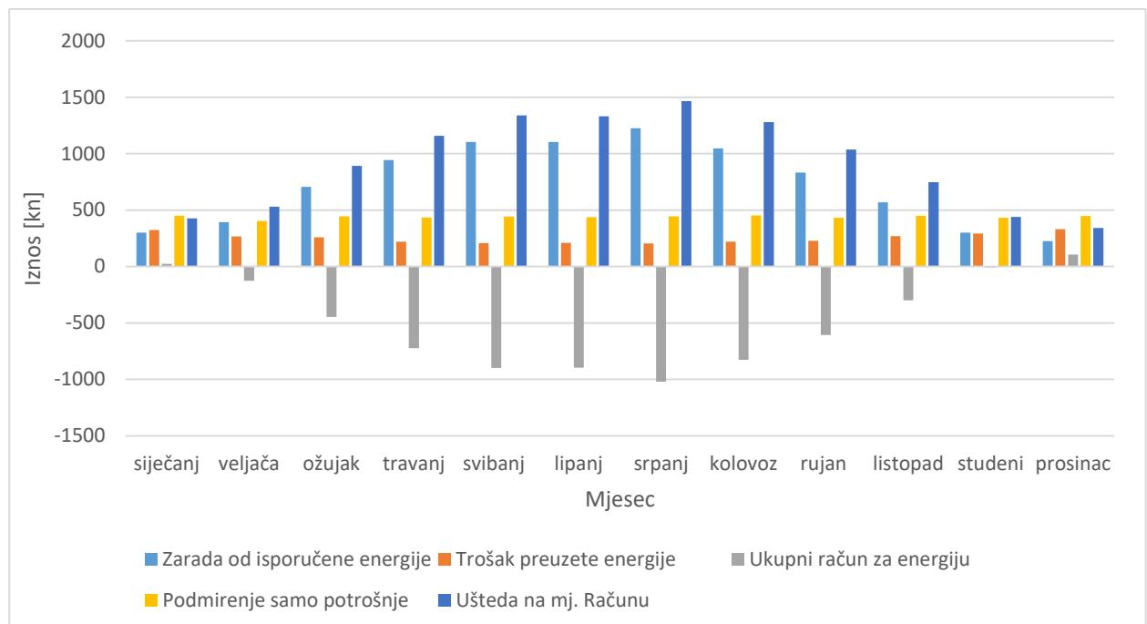
Slika 4.3. Mjesecni tok novca za sustav snage 18 kW
