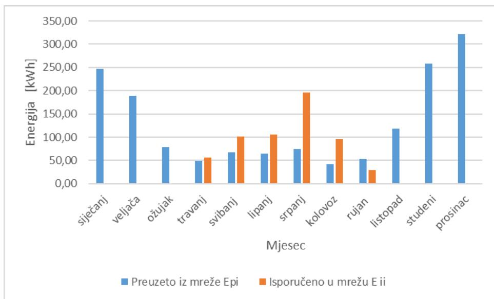
Slika 4.17. Mjesecni tok električne energije za sustav snage 4,5 kW plus 2 baterijski sustav pohrane
