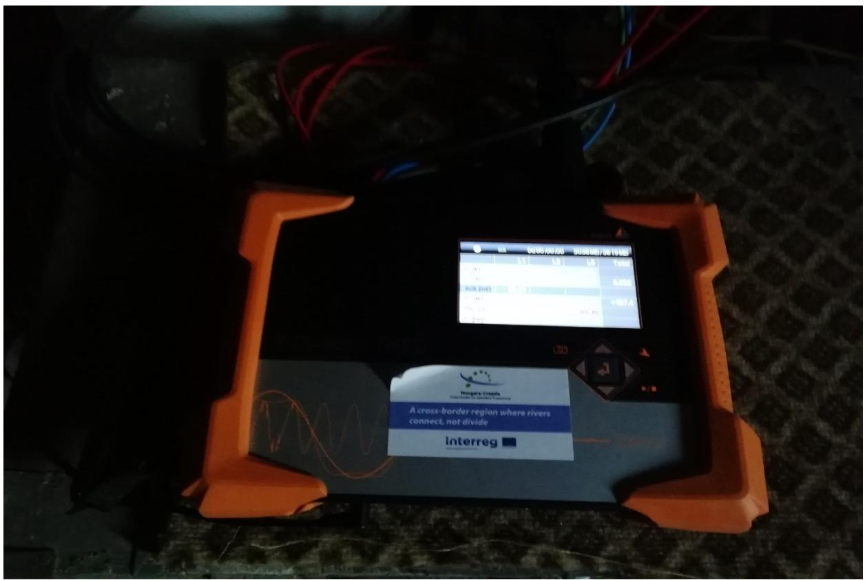
Slika 3.12. Mjerni uređaj A.Eberle PQ Box 200
