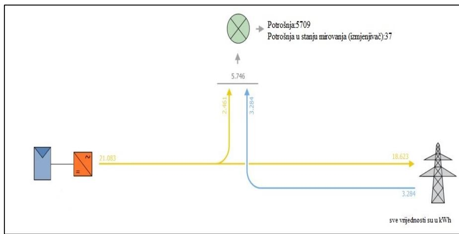
Slika 4.2 Godišnji tok električne energije za sustav za fotonaponskom elektranom instalirane snage 18 kW
