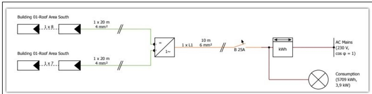
Slika 4.4. Shematski prikaz fotonaponskog sustava snage 4,5 kW
