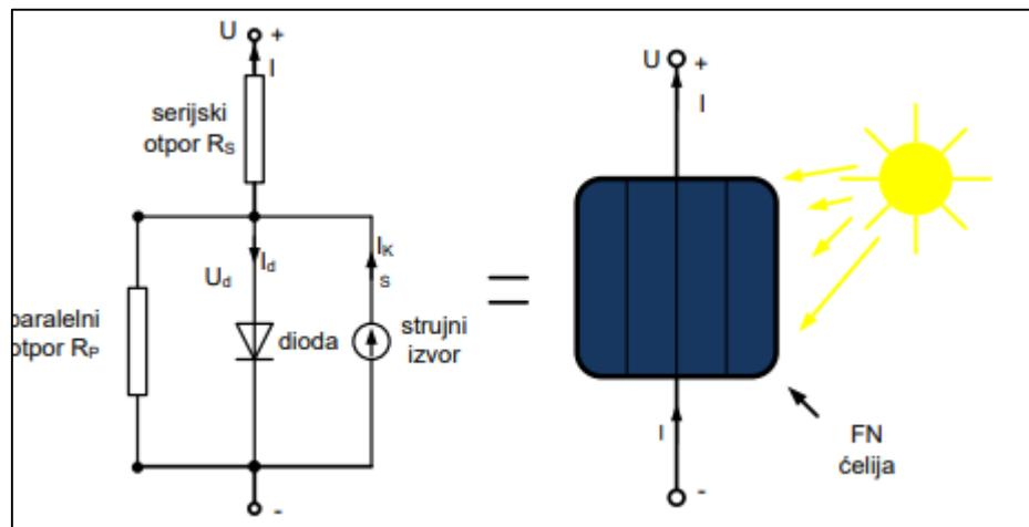
Slika 2.1. Nadomjesna shema fotonaponske ćelije [1]
