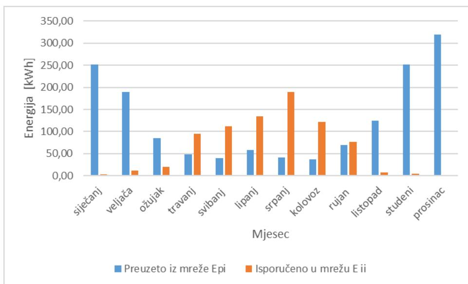
Slika 4.12. Mjesecni tok električne energije za sustav snage 4,5 kW plus 1 baterijski sustav pohrane
