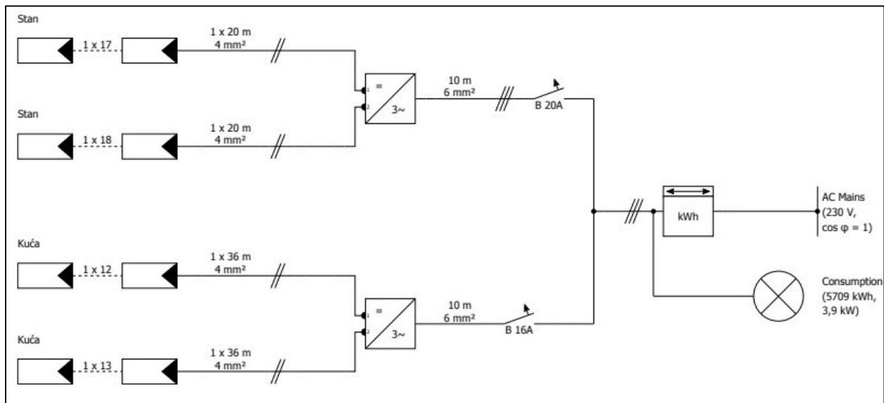
Slika 4.1. Jednopolna shema fotonaponskog sustava snage 18 kW
