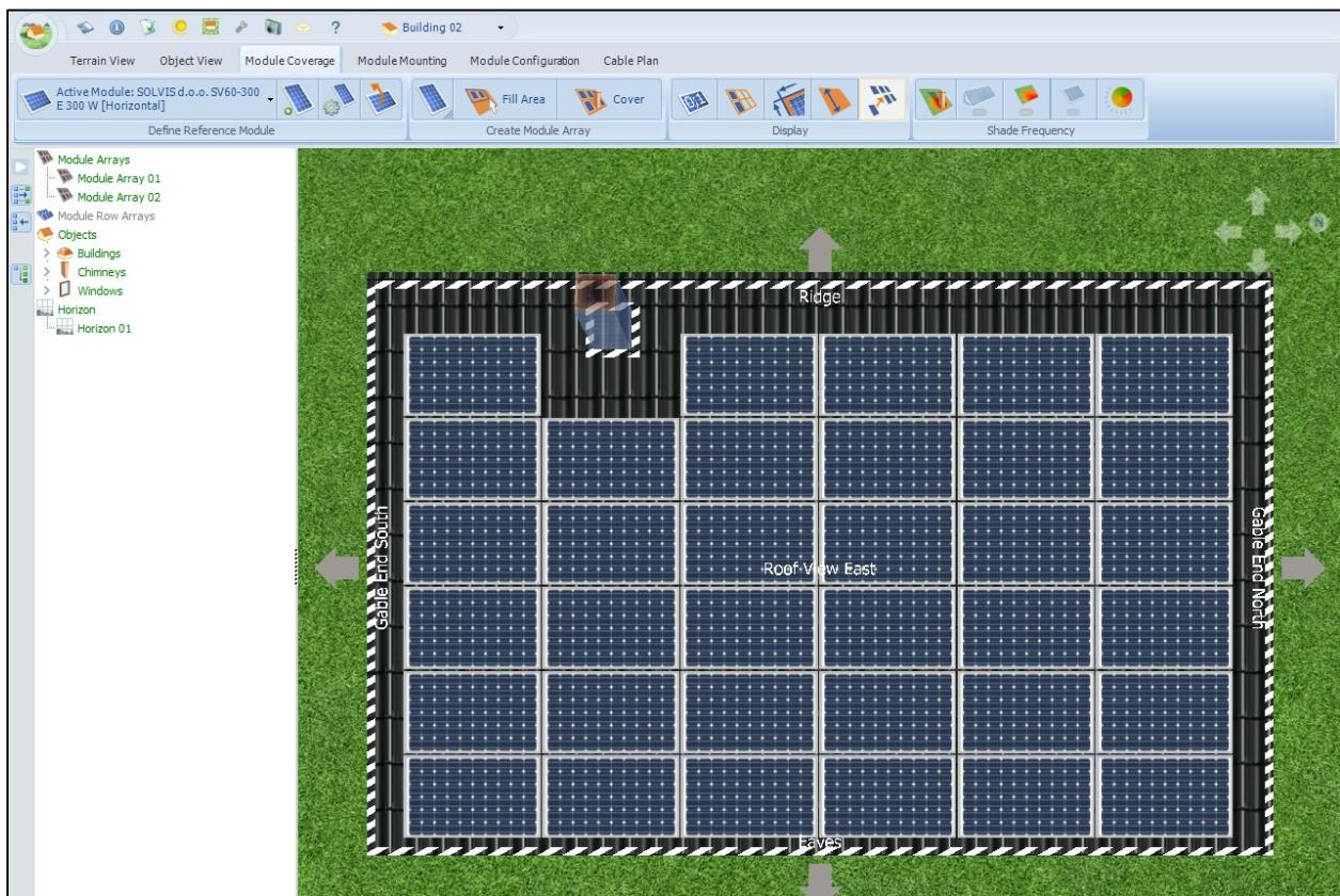
Slika 3.6 Automatsko raspoređivanje modula na površini krova stana
