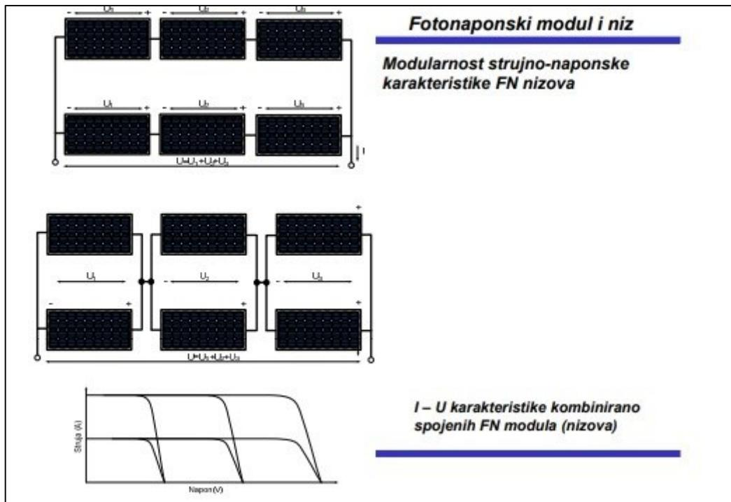
Slika 2.3. Fotonaponski moduli, nizovi i njihove strujno - naponske karakteristike [2]
