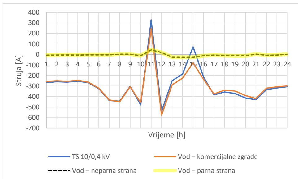
Slika 5.39. Strujna opterećenja za 2. slučaj promjenjivog dana
