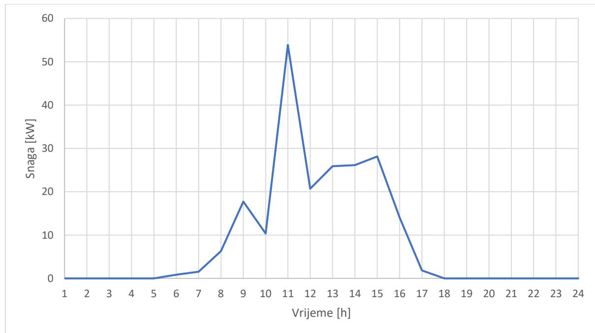
**Slika 5.6. Profil proizvodnje fotonaponske elektrane zgrade fakulteta za promjenjivi dan**
