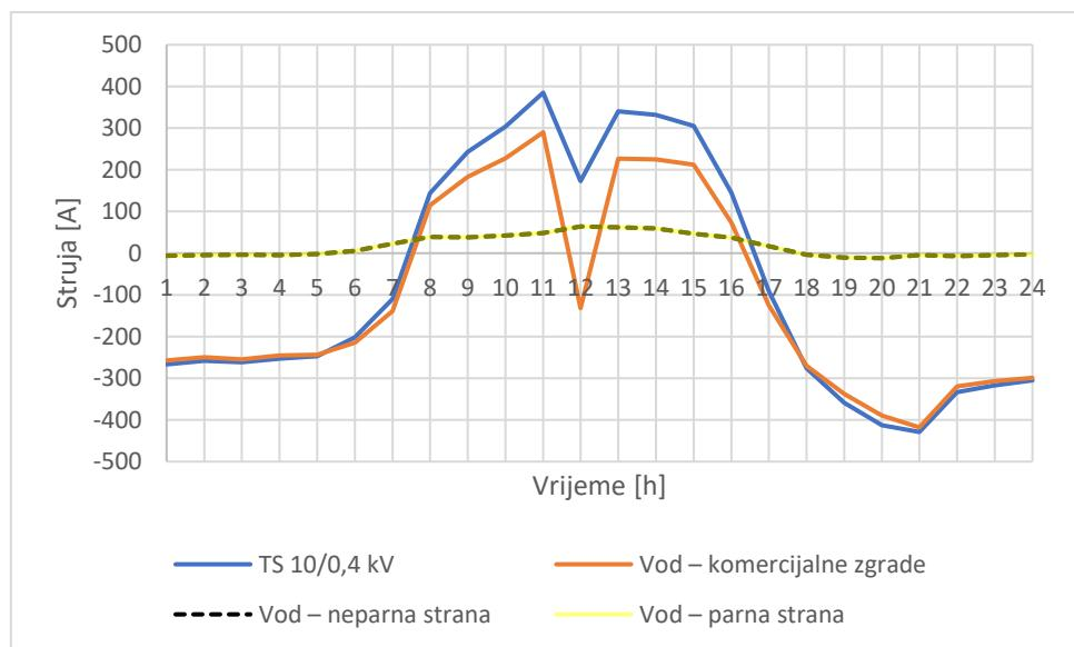
Slika 5.33. Strujna opterećenja za 2. slučaj sunčanog dana
