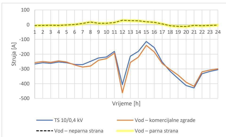
Slika 5.20. Strujna opterećenja za 1. slučaj sunčanog dana
