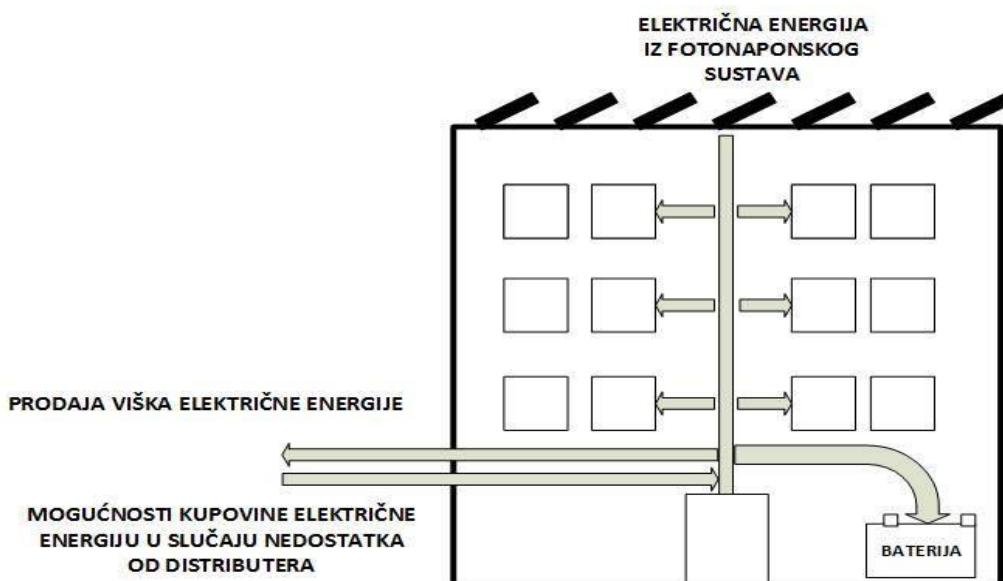
**Slika 4.6. Zgrada gdje investitor prodaje električnu energiju stanarima**
