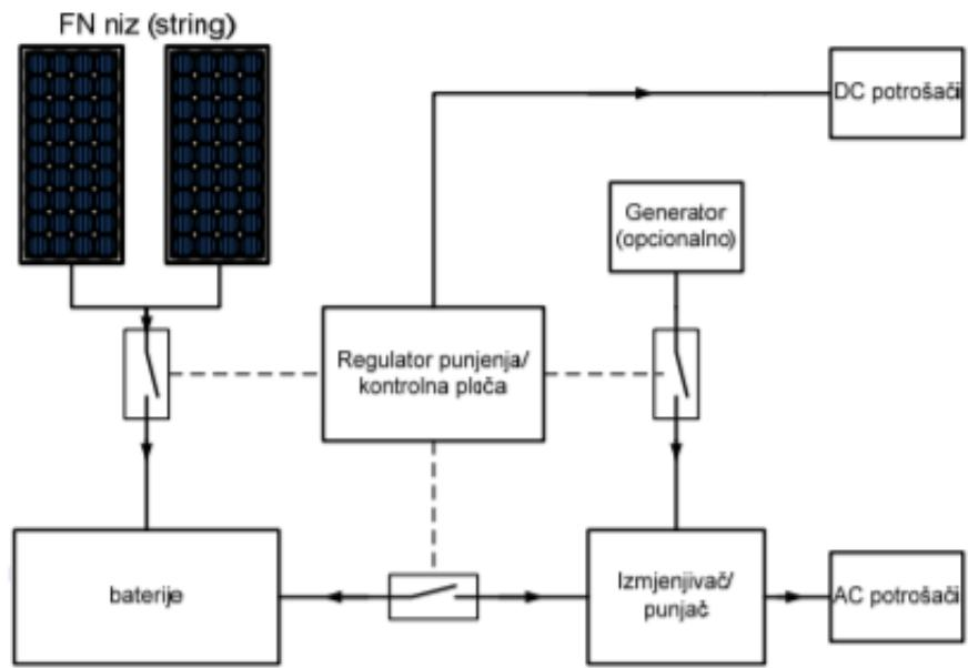
**Slika 3.1.** Autonomni fotonaponski sustav [11]
