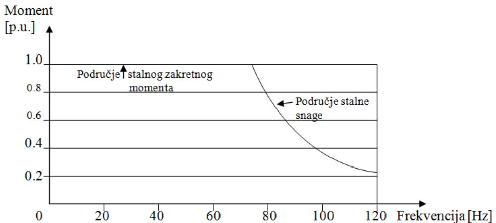
Slika 3.13. Izlaz konstantnog pogona promjenjive frekvencije okretnog momenta, [2]
