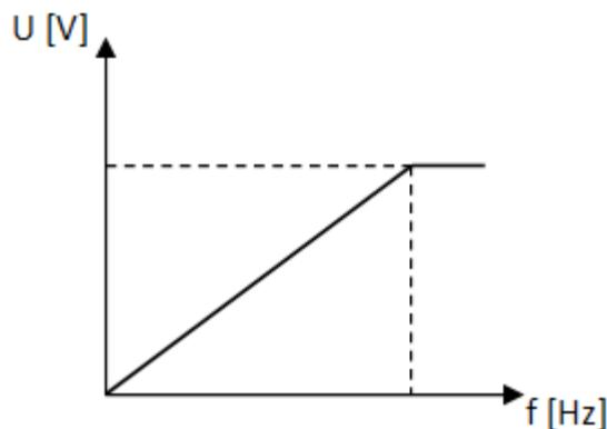
Slika 4.2. Prikaz izlaznog napona i frekvencije, [3]
