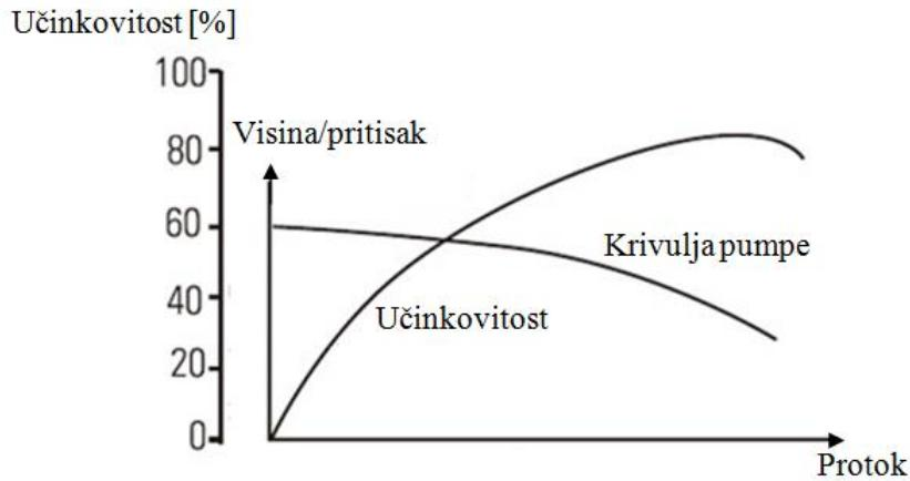
Slika 3.10. Učinkovitost pumpe s fiksnom brzinom, [2]
