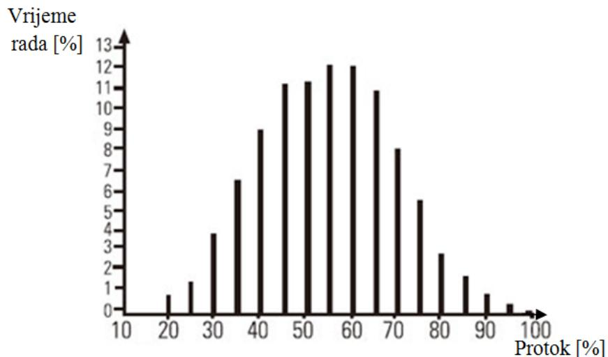
Slika 3.6. Tipični radni ciklus centrifugalne crpke, [2]
