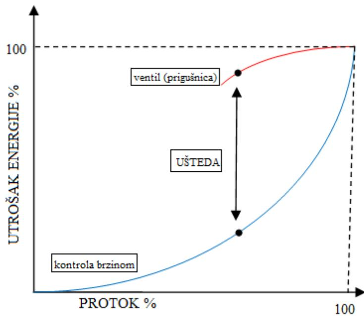
Slika 4.5. Usporedba utroška energije između kontrole protoka ventilom (ili drugim prigušivačem) i upotrebom frekventnog regulatora, [3]
