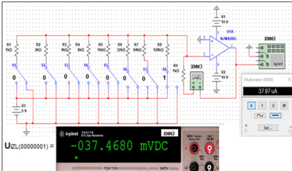
Slika 3.7 Shema težinskog D/A pretvarača u multisim programu s mjerjenjem doprinosa LSB
