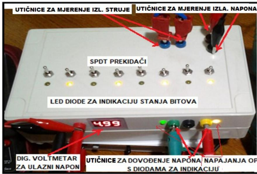
Slika 3.10 Vanjski raspored elemenata težinskog D/A pretvarača
