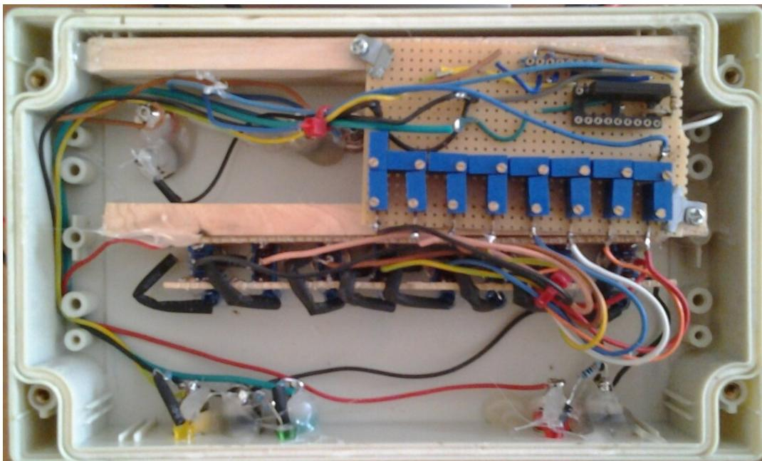
Slika 4.16 Unutrašnji raspored elemenata R2R D/A pretvarača
