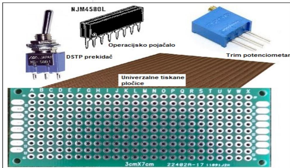
Slika 3.8 Osnovne komponente za realizaciju D/A pretvarača
