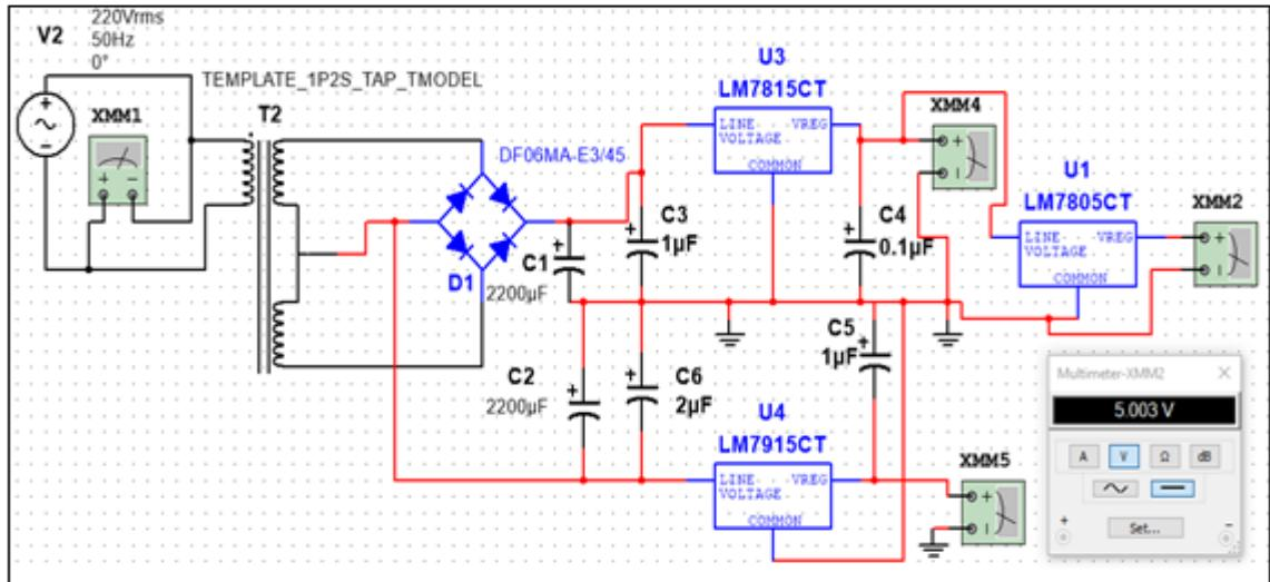
Slika 3.6 Dobivanje referentnog napona +5V iz simetričnog ispravljača
