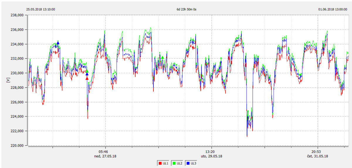
Slika 4.7. Usrednjene desetminutne efektivne vrijednosti napona
