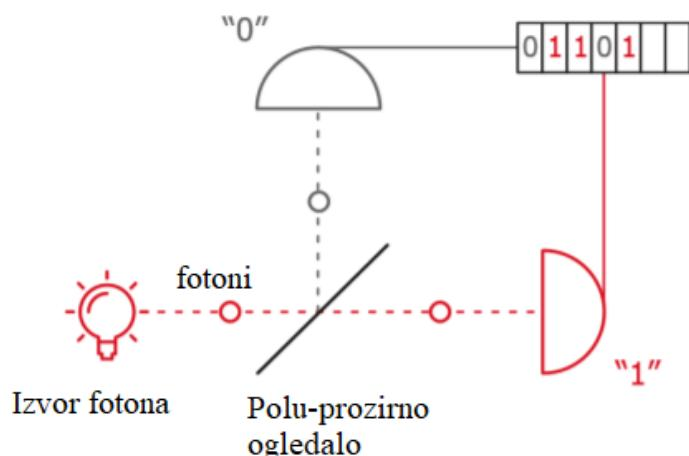
Sl. 4.1. Shematski prikaz principa optičkog sustava kvantnih generatora [10]
