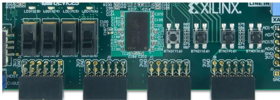
**Sl. 4.8.** Fizički smještaj kliznih sklopki (sredina-lijevo), tipkala (sredina-desno) i LED-ica (gore-lijevo) na ZYBO pločici [13].
