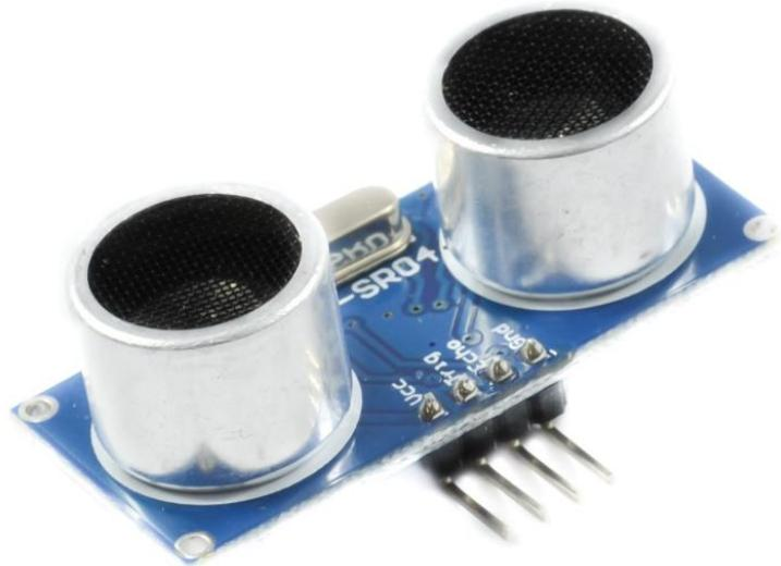
**Sl. 3.11.** Senzor za mjerjenje udaljenosti HC-SR04 [16].
