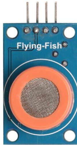
**Sl. 3.6.** MQ3 Senzor plinova [12].
