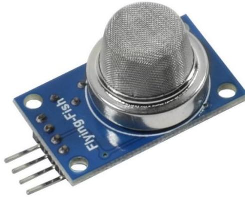
**Sl. 3.5.** MQ135 Senzor plinova [11].
