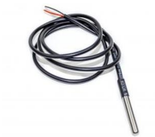
Sl. 3.4. DS18B20 Senzor Temperature [10].
