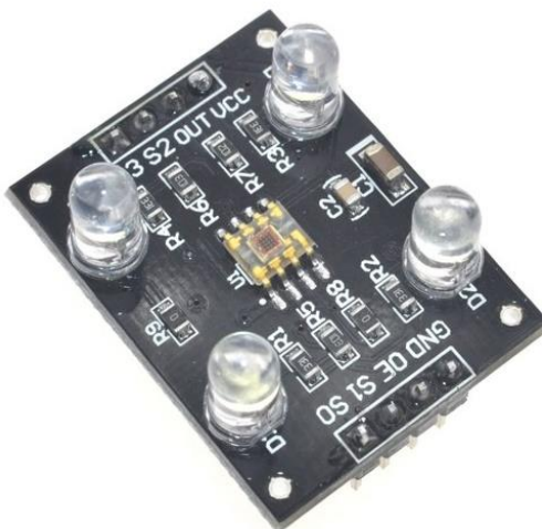
Sl. 3.10. TCS230 Senzor a prepoznavanje boja [15].
