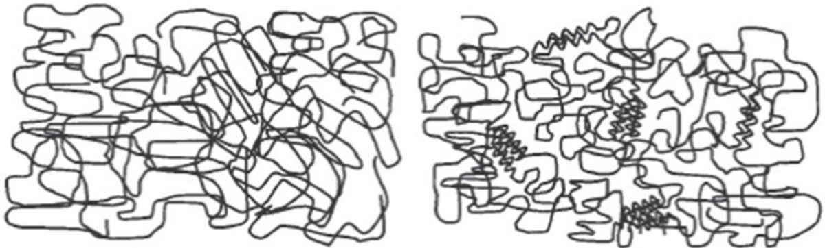
Slika 2.6 Prikaz amorfne i kristalaste strukture plastomera [11]
