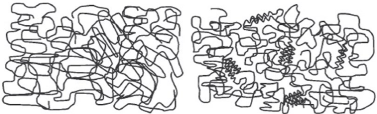
Slika 2.6 Prikaz amorfne i kristalaste strukture plastomera [11]
