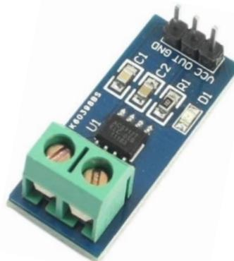
S1.3.9. Strujni mjerni senzor ACS712T ELC-05B [7]
