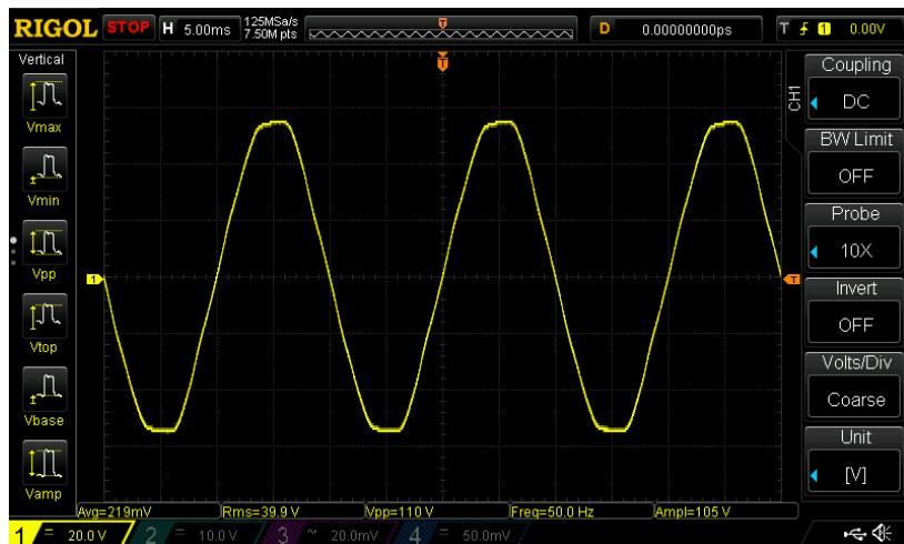
S1.3.6. Valni oblik napona na otporu  $R_1$
