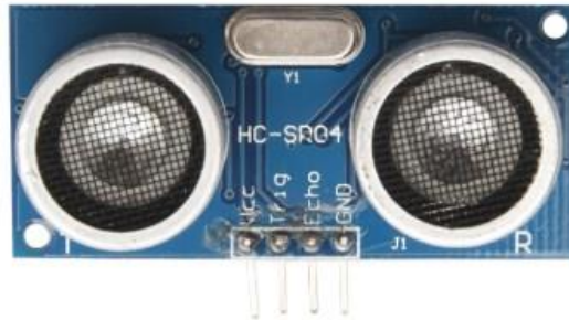
Slika 12.2.: HC-SR04 ultrazvučni modul 21
