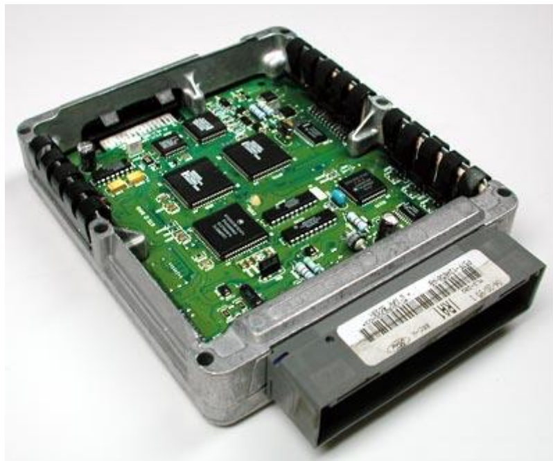
Slika 2.1.: Glavno računalo iz Ford Ranger automobila 1
