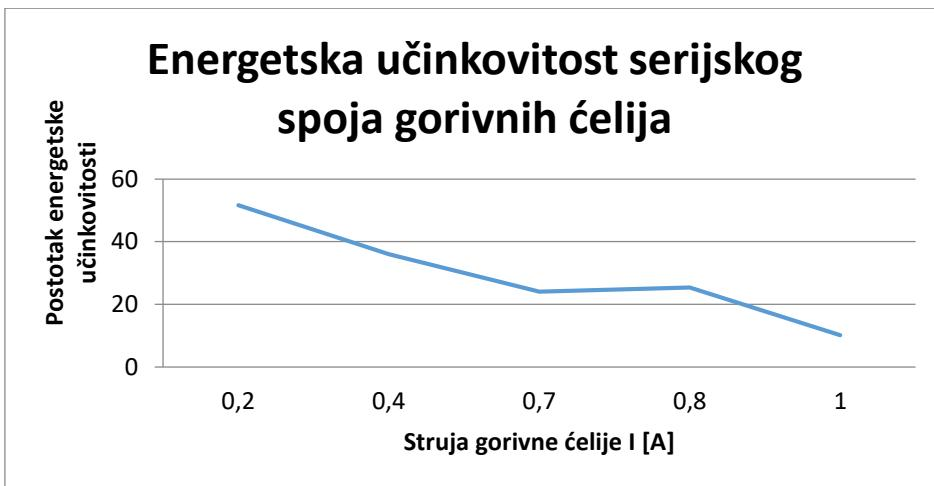
Slika 4.3 Ovisnost energetske učinkovitosti u postocima o struji gorivne čelije
