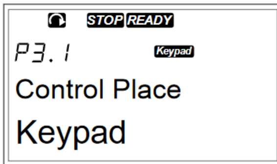
Slika P1.5. Izgled zaslona nakon izvršene naredbe 6 [9]
