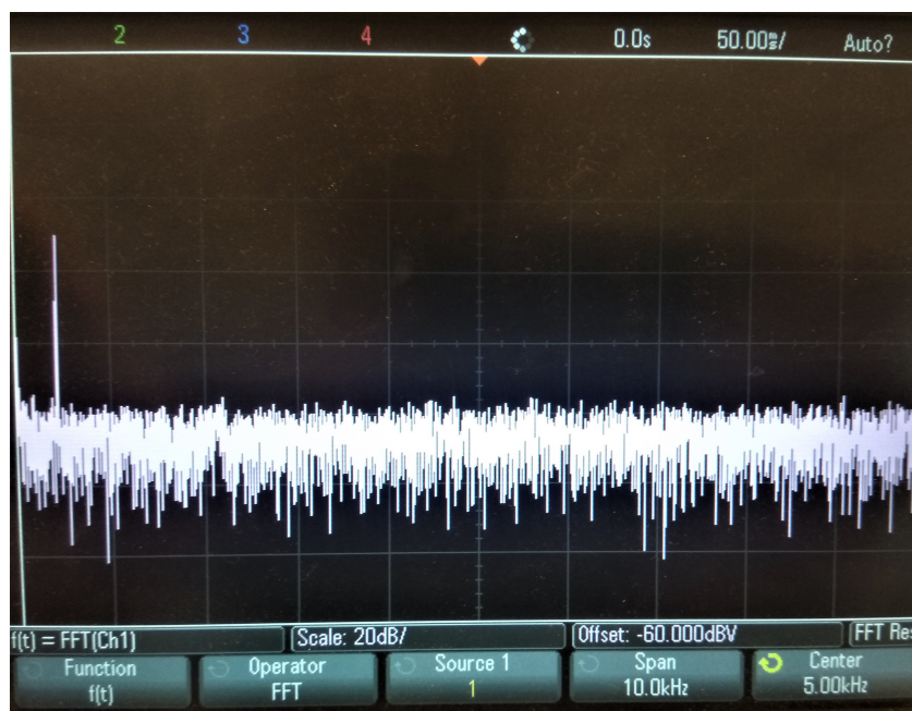
Slika 4.8. Spektar izlaznog signala za sinusoidalni ulazni signal 440 Hz i amplitudu 50 mV
