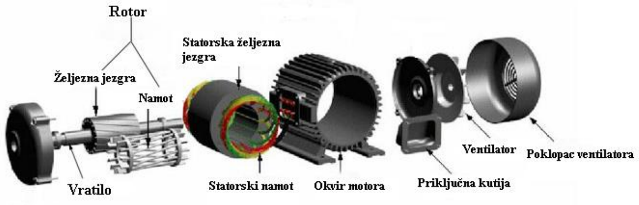
Slika 5.1 Građa asinkronog motora [8]
