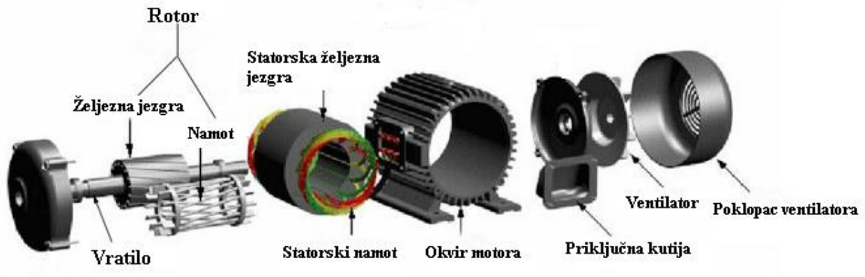
Slika 5.1 Građa asinkronog motora [8]
