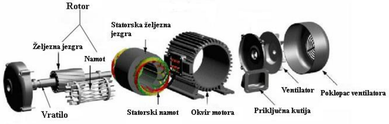
Slika 5.1 Građa asinkronog motora [8]
