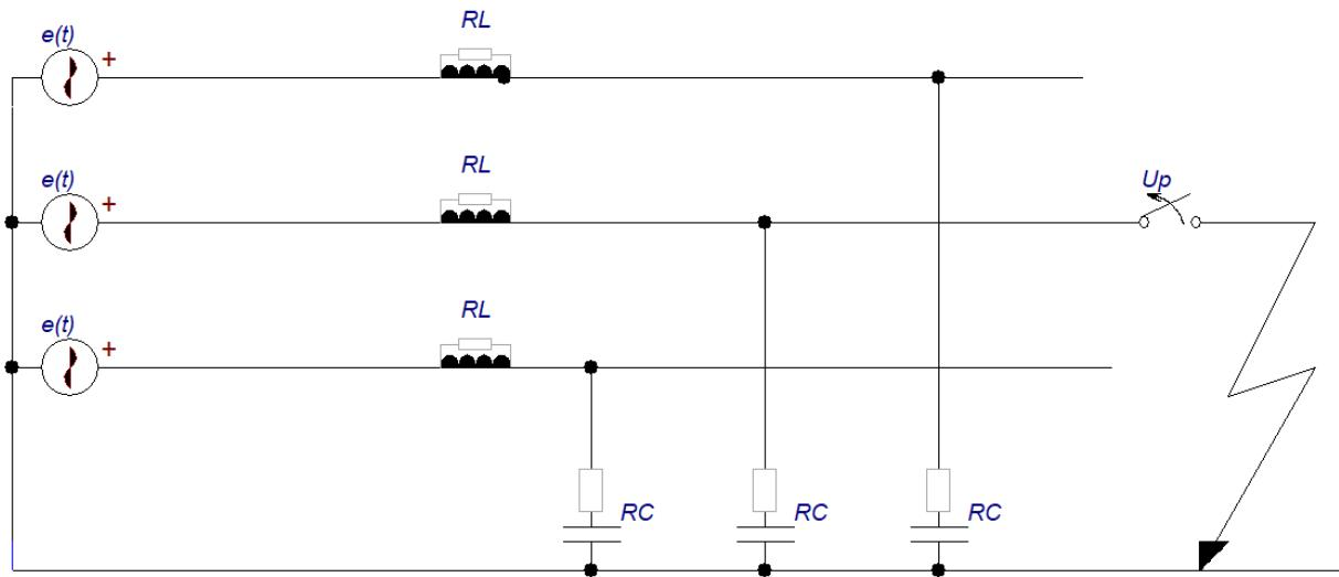
Sl. 4.10. Prenapon uslijed isklapanja kratkog spoja. [10]
