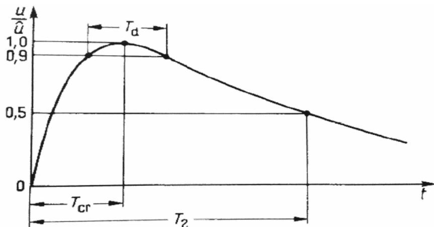
Sl. 2.4. Udarni napon karakterističan za sklopne prenapone. [11]
