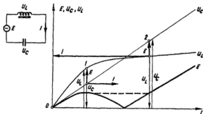
Sl. 2.2. Prikaz ferorezonancije i naglog povećanja napona na induktivitetu i kapacitetu. [11]
