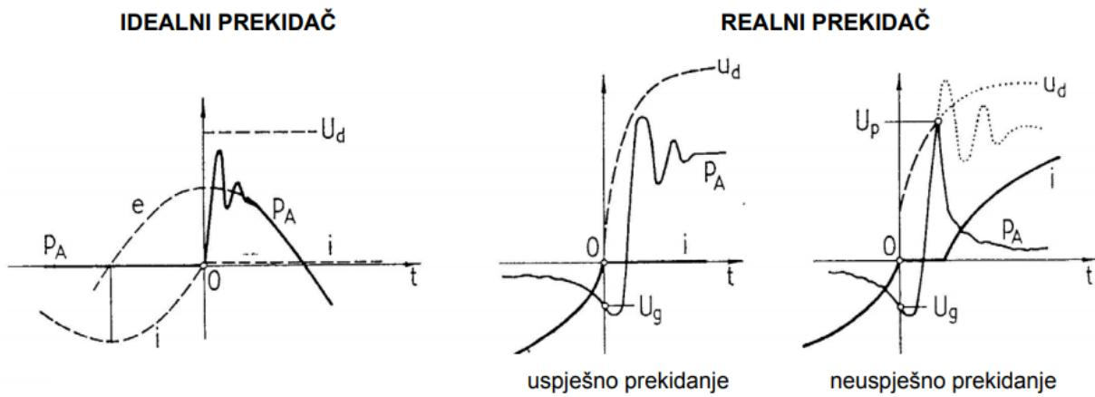
Sl. 3.3. Prekidanje struje realnim i idealnim prekidačem. [10]
