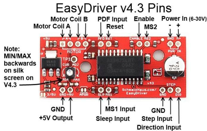
Slika 2.3. Upravljač koračnog motora.<sup>4</sup>
