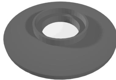
Slika 3.4. Novi 3D model za smanjivanje prodora vanjske svijetlosti u kućište senzora.
