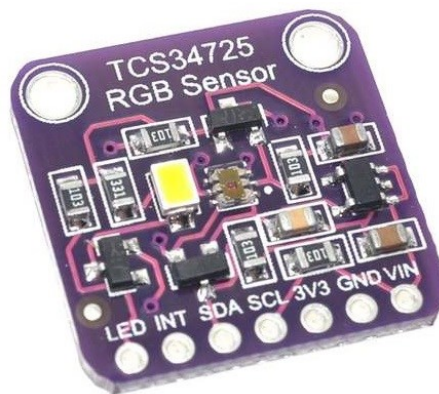
Slika 2.4. TCS34725 senzor boje. 5
