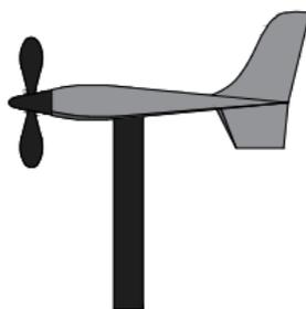
Slika 7. Propelerni anemometar [8]
