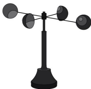
Slika 6. Anemometar s lopaticama [8]
