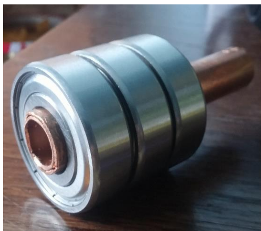
Slika 3.2. Bakrena cijev sa tri kuglična ležaja
