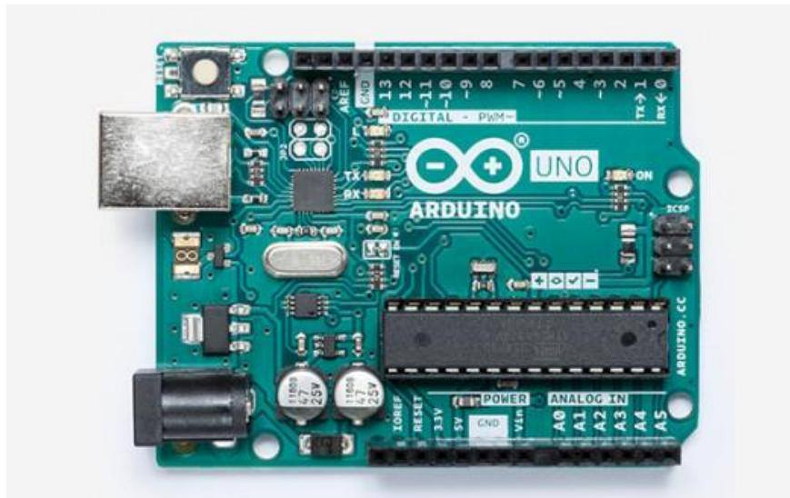
**Slika 2.1.** Arduino Uno ploča
