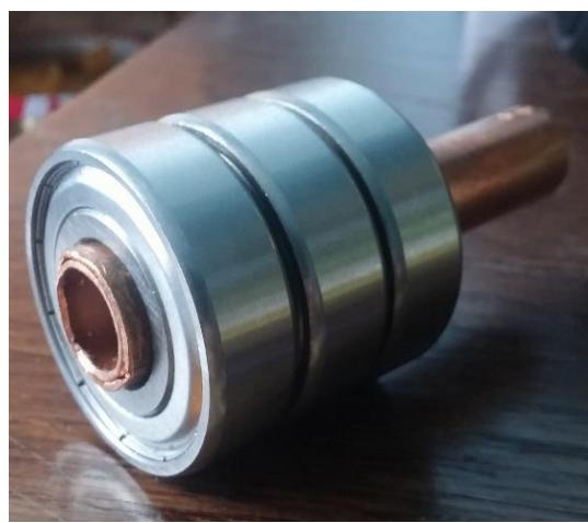
**Slika 3.2.** Bakrena cijev sa tri kuglična ležaja
