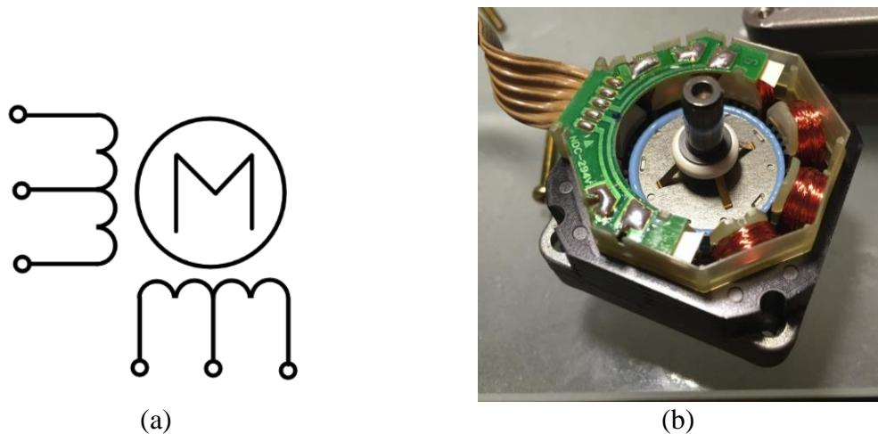
**Slika 2.4.** Model unipolarnog koračnog motora (a); Unutrašnji prikaz unipolarnog motora (b).
