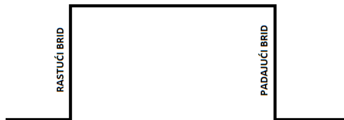
Slika 4.5. Rastući i padajući brid
