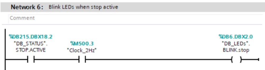
Slika 4.15. Treptanje LED žaruljice kada je stop aktiviran
