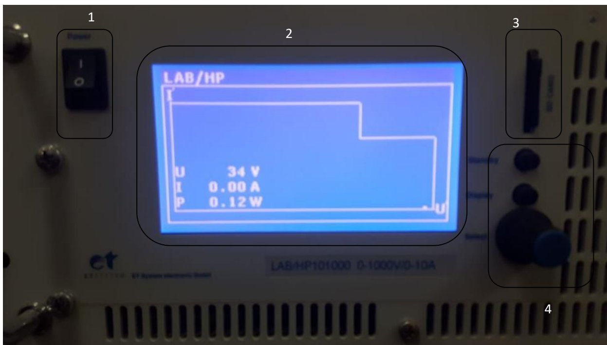
Slika 2.3. Prikaz prednje upravljačke ploče istosmjernog izvora
