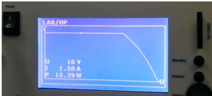
Slika 4.6. Položaj radne točke za vrijeme 2 minute izvršenja karakteristike
