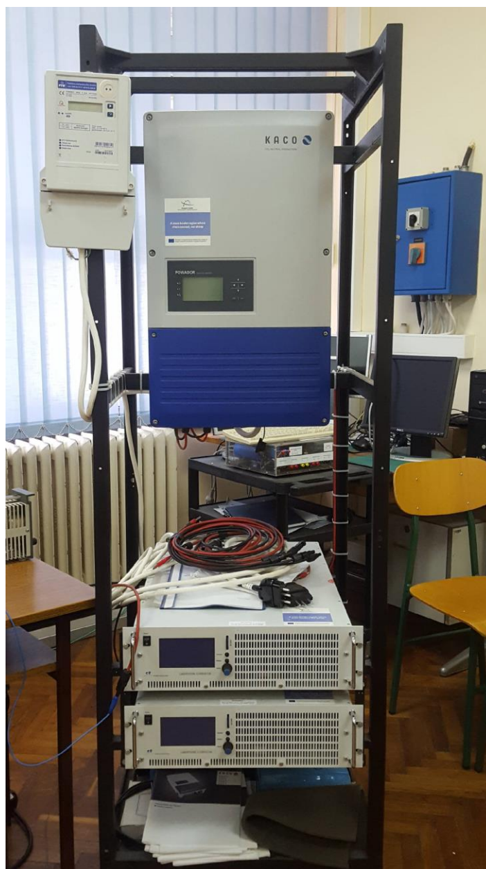
Slika 2.1. Emulator fotonaponskog sustava
