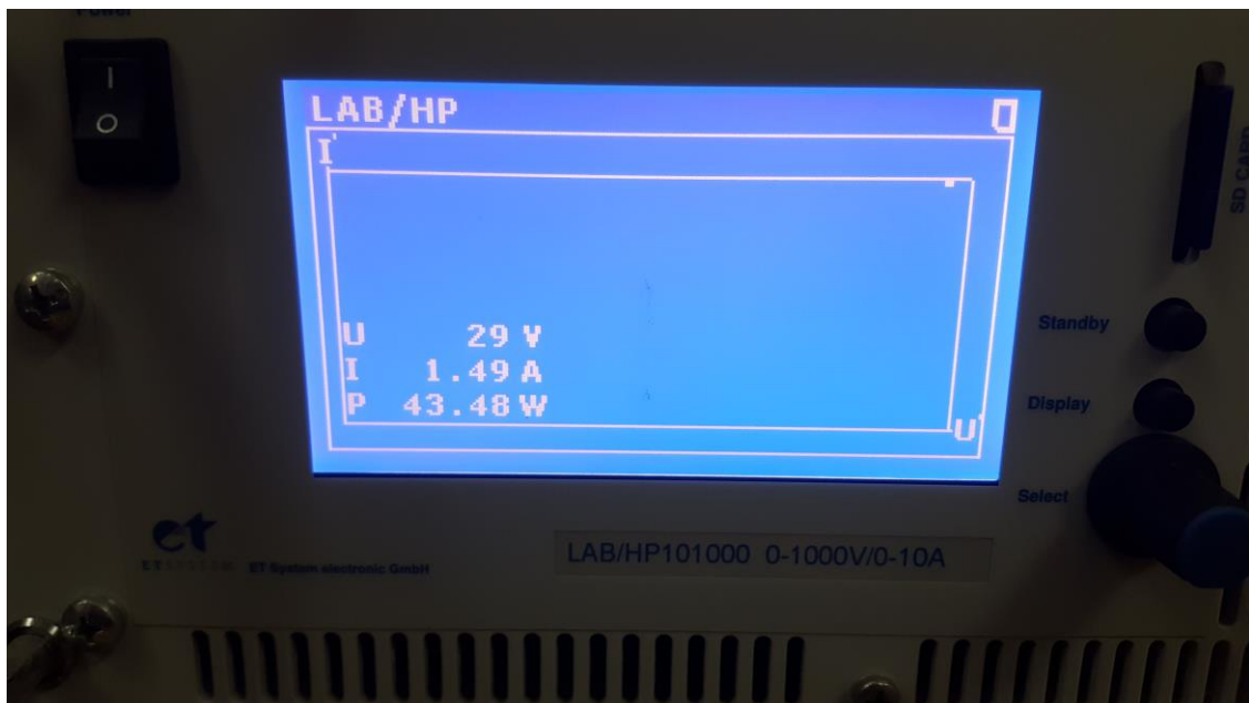
Slika 3.6. Radna točka na UI karakteristici
