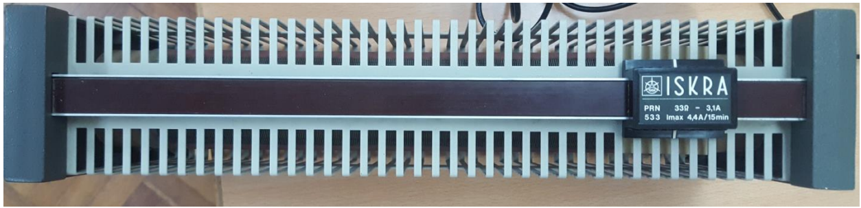
Slika 3.2. Promjenjivi žični otpornik
