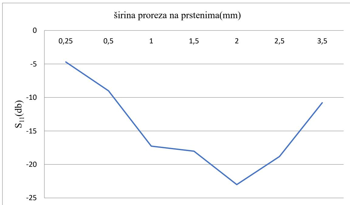
Ovaj graf prikazuje ovisnost parametra  $S_{11}$  od veličini širine proreza na unutarnjem i vanjskom prstenu metamaterijalne antene.
