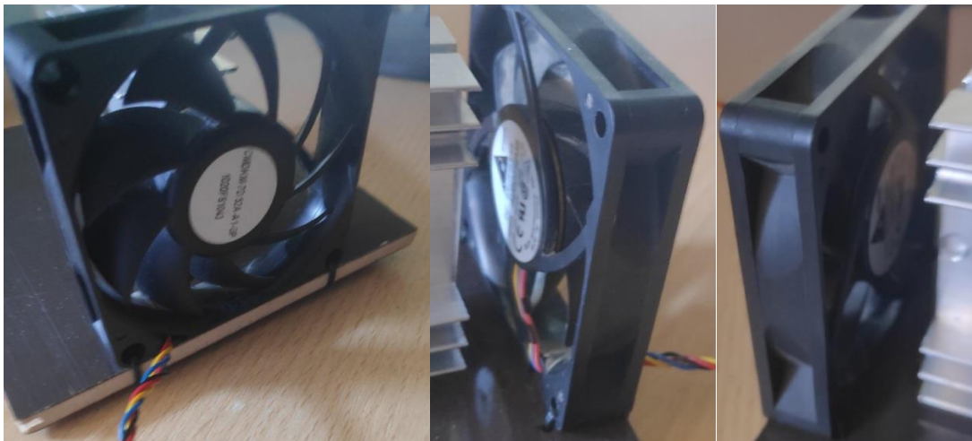
Slike 3.19., 3.20. i 3.21. Fizička montaža prijenosnika topline
