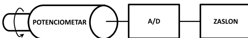
Slika 2.7 - Mjerenje i prikaz rotacijskog pomaka korištenjem potencijometra [1]
