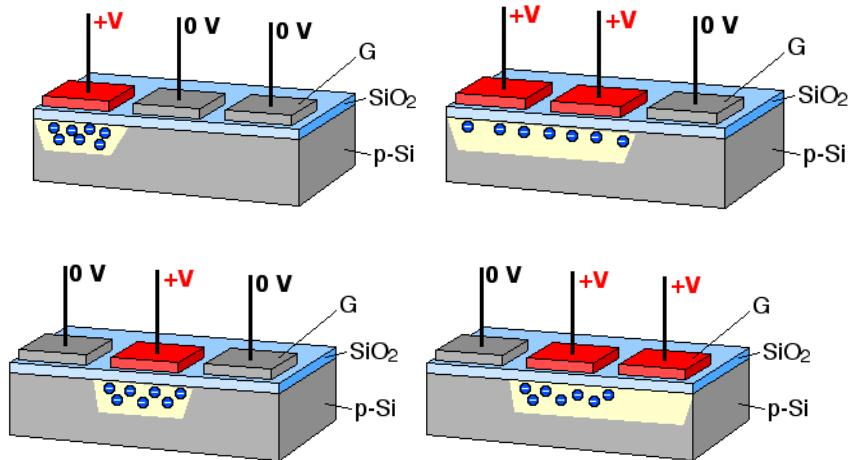
**Sl. 4.2.3.** Primjer rada kondenzatora kao pomicnog registra
