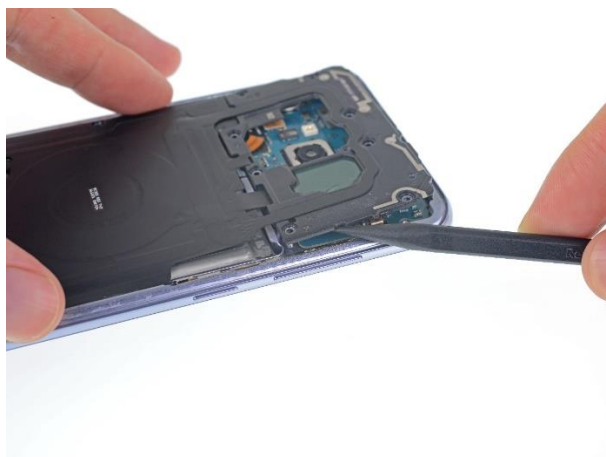
Sl. 5.2.2. Postupak daljnjeg rastavljanja mobitela, [22]
