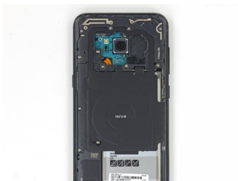
Sl. 5.2.1. Unutrašnjost mobitela bez stražnjeg stakla, [22]
