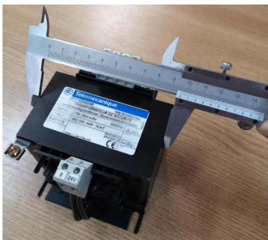
**Slika 4.1** Mjerenje dimenzija površina transformatora
