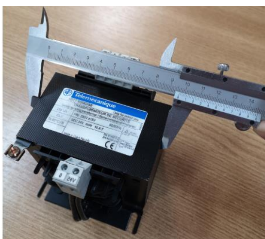
Slika 4.1 Mjerenje dimenzija površina transformatora
