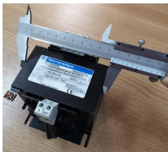
**Slika 4.1** Mjerenje dimenzija površina transformatora
