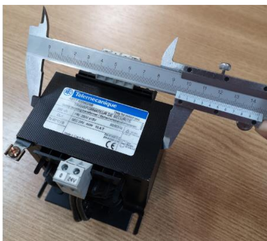
Slika 4.1 Mjerenje dimenzija površina transformatora
