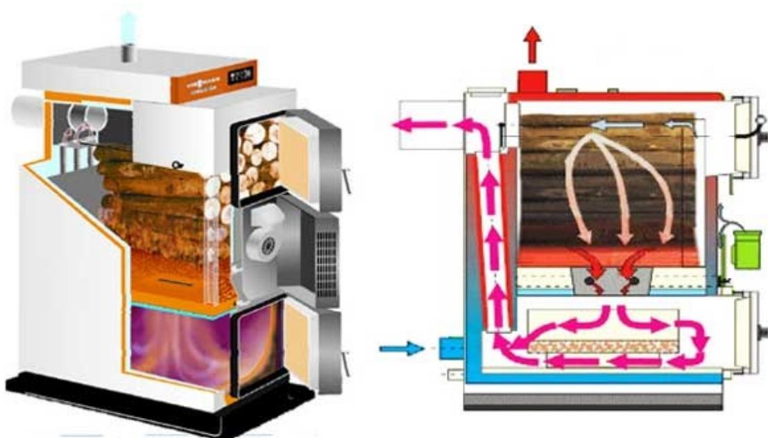
Slika 5.2.: Izgled pirolitičke peći/bojlera [10]
