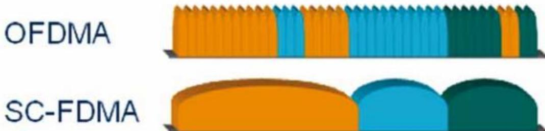
*Slika 3.5. Usporedba OFDMA i SC-FDMA pristupa[8].*
