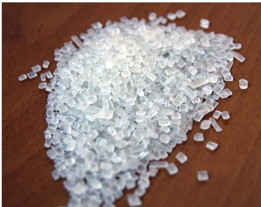
Slika 2.1. Polietilen tereftalat u granularnom obliku
