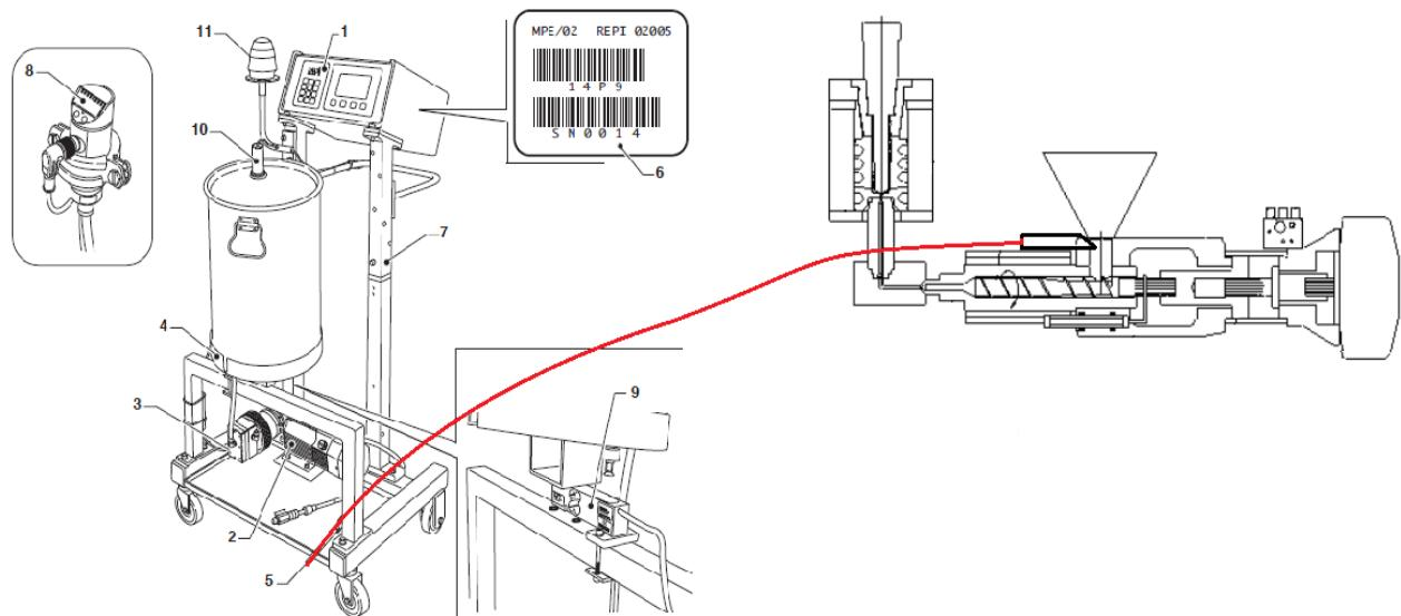
**Slika 3.18.** Prikaz doziranja direktno u jedinicu za ubrizgavanje
