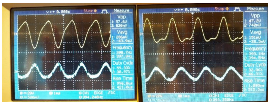
Slika 4.6.: Lijevo je signal kad su bass, mid i treble smanjeni, a desno je signal kad je treble pojačan
