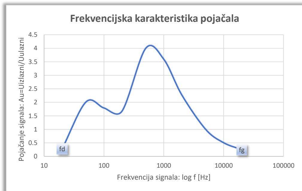
Slika 4.4: Frekvencijska karakteristika pojačala
