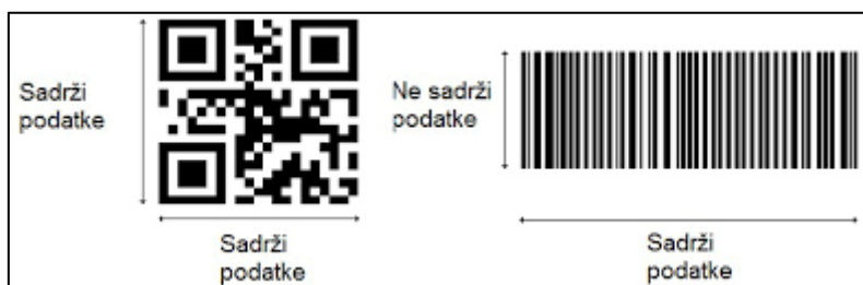
Slika 2.3. Razlika između QR koda i jednodimenzionalnog koda 1
