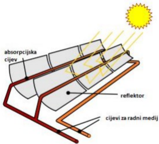
Slika 3.5. Jednostavni prikaz funkcioniranja paraboličnog žljebastog kolektora [5]
