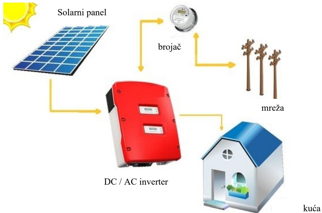
Slika 4.8. On grid solarni sustav [11]
