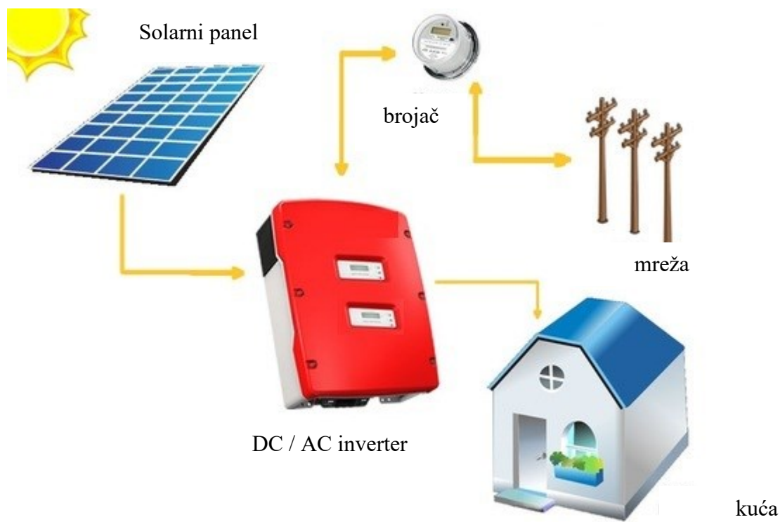
Slika 4.8. On grid solarni sustav [11]
